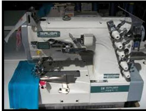
**Ilustración 22 Máquina recubridora**
