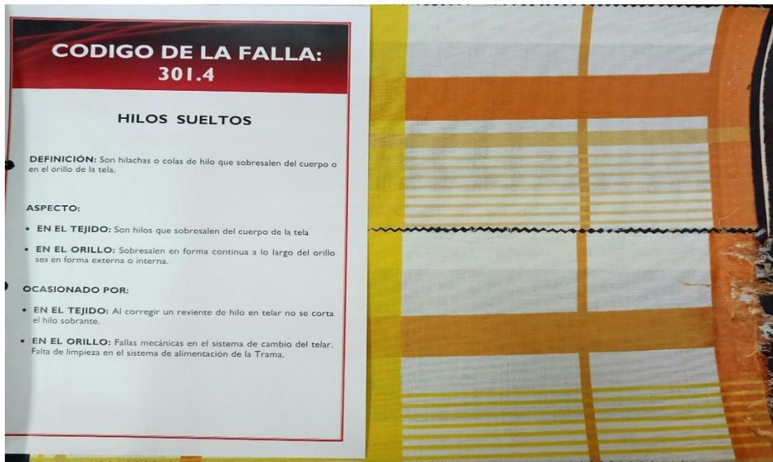
Figura N. 38: Falla de hilo suelto
