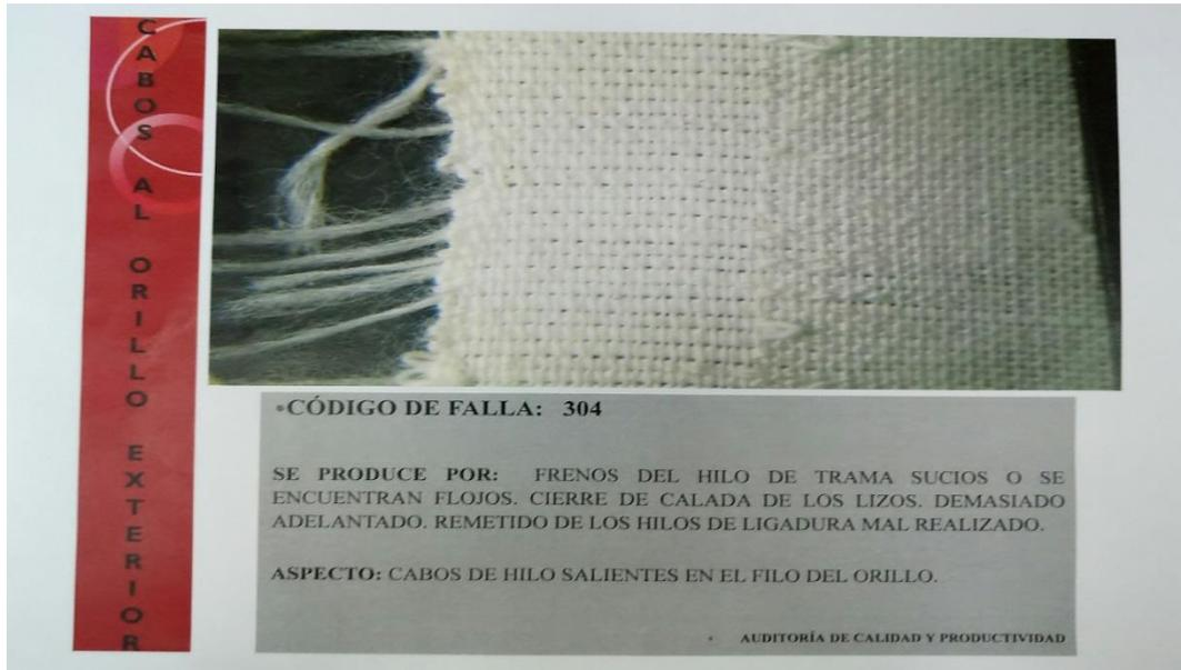
Figura N. 30: Cabos al orillo exterior
