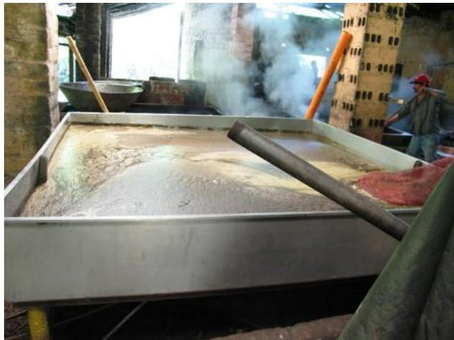
Tanque de acero inoxidable donde llega el zumo de la caña. La espuma que se forma en la parte superior de le llama cachaza y se recoge con unos cucharones grandes.
