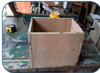
3. Una vez ya que clavamos los lados del cajón vamos a realizar en círculo en el medio con el compás para poder realizar el hueco del cajón.
